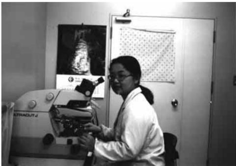
ウルトラマイクローム(電子顕微鏡用の超薄切片を作る機械)を操作する王奕さん
